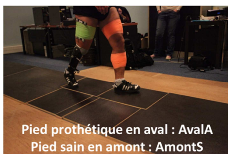
Figure 61 : Illustration de la condition de marche étudiée : le pied prothétique est en aval du dévers et le pied sain est en amont
