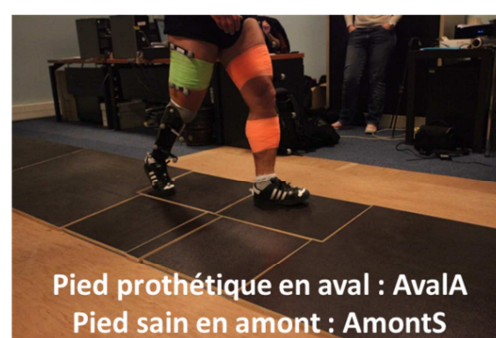
Figure 52 : Représentation des cycles enregistrés en dévers pour une personne amputée transtibiale à droite. Lorsque le pied prothétique est en amont et le pied sain en aval les cycles enregistrés sont appelés AmontA et AvalS (image de gauche), et lorsque le pied prothétique est en aval et le pied sain en amont les cycles enregistrés sont appelés AvalA et AmontS (image de droite).
