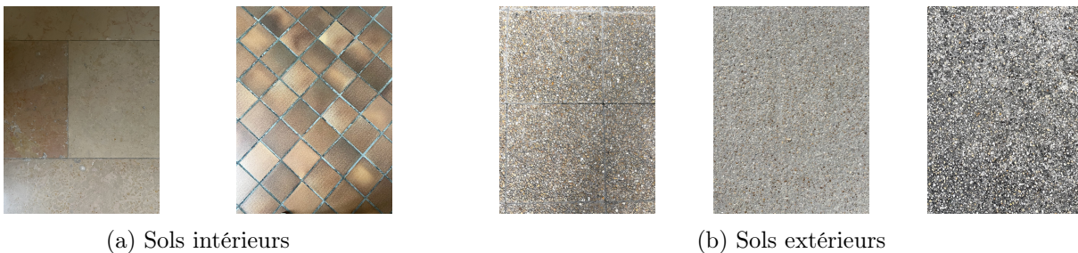
FIGURE 1.1 – Photographies des deux revêtements de sols intérieurs (des carreaux de marbre et des carreaux de terre cuite) (a), et des trois revêtements de sols extérieurs (des dalles de béton, asphalté gris clair et route asphalté endommagée) (b) utilisés pour étudier l'exposition aux vibrations pendant la propulsion quotidienne.
