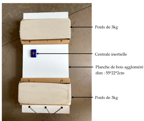
(a) Outil de calibration pour mesurer l'index vibratoire du sol
