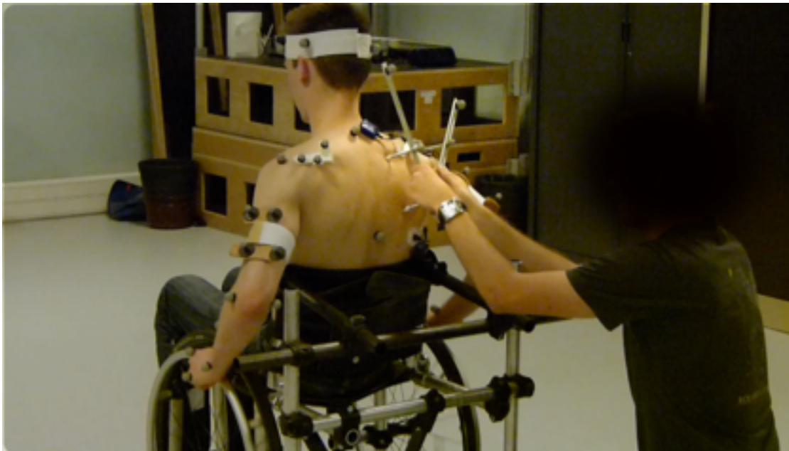
FIGURE 3.5 – Photographie du système expérimental avec le sujet équipé de marqueurs, dont un cluster de marqueur (à droite et à gauche), assis dans l'ergomètre statique. L'expérimentateur tient le SP et suit le mouvement de la scapula droite du sujet
